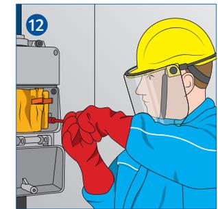
12 Bei Gefährdung durch Störlichtbögen Elektrikerschutzkleidung tragen.
