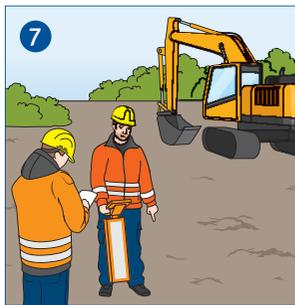
7 Vor Bohr-/Baggerarbeiten prüfen: Sind in der Nähe unter Spannung stehende Leitungen vorhanden?
