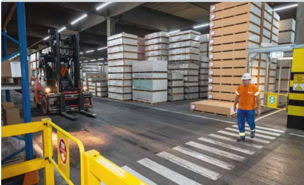
Kreuzungspunkte von Fußgängern und Gabelstaplern sind mit Türen gesichert, die auf- und wieder zugemacht werden müssen. Zebrastrifen und Deckenspiegel sorgen für zusätzliche Sicherheit im gemeinsam genutzten Verkehrsraum.
