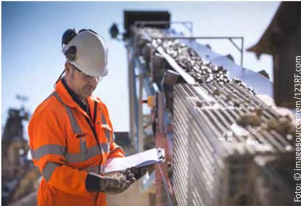
Stetig surren sie dahin. Scheinbar harmlos und ungefährlich. Doch bei Arbeiten am laufenden Band werden Förderbänder zu lebensgefährlichen Anlagen. Kleidung, Handschuhe, Werkzeuge können an ungesicherten Trommeln und Rollen eingezogen werden. Förderbandunfälle führen oft zu schwersten Verletzungen an Körper, Armen und Händen. Beim Sturz auf Förderbänder droht ein lebensgefährlicher Ritt durch die Anlage.
