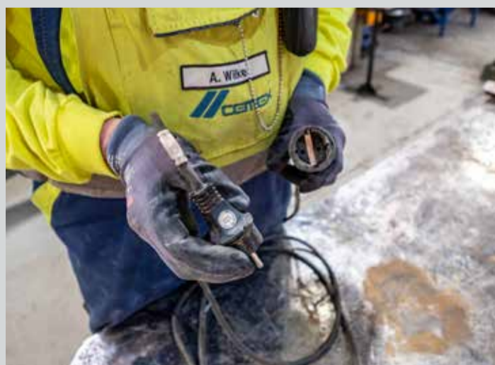
Bei der Sichtkontrolle werden Arbeitsmittel auf augenscheinliche Mängel hin untersucht und gegebenenfalls aussortiert. In der Werkstatt wird geprüft, was zu reparieren ist.
