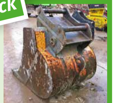
Baggerschaufel mit Lasthaken und Aufnahme für die Schnellwechseinrichtung.
