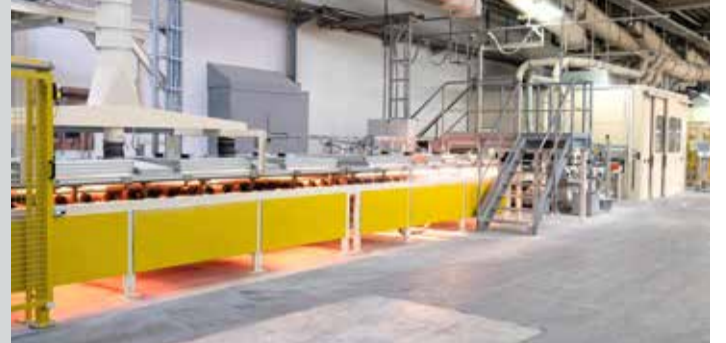
Eine saubere, aufgeräumte Sache – die Fertigungsstraße zur Oberflächenveredelung für Gipsfaserplatten bei Knauf Integral.
