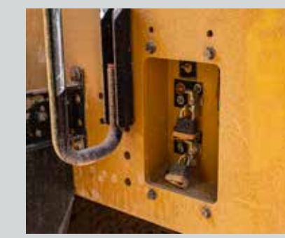
Das Lockout-Tagout-System verhindert den Zugang zum Gefahrenbereich und ermöglicht sichere Wartungsarbeiten an dieser Erdbaumaschine.
