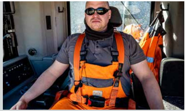
Der 5-Punkt-Gurt hält den Erdbaumaschinenführer an Schultern und Hüfte – den stabilsten Punkten am Körper – im Sitz und sorgt so bei einem möglichen Unfall für größtmögliche Sicherheit.
