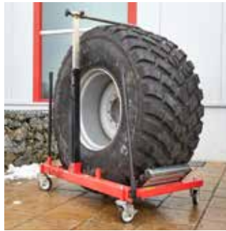
Der Reifen steht sicher auf dem Rollentisch und kann überallhin transportiert werden.
