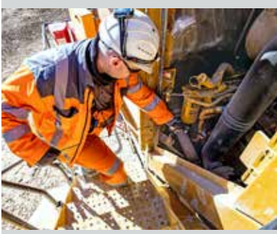
Bei der täglichen Fahrzeugkontrolle werden neben der Sichtprüfung auch Ölstand, Beleuchtung, Reifen und Bremsen kontrolliert.
