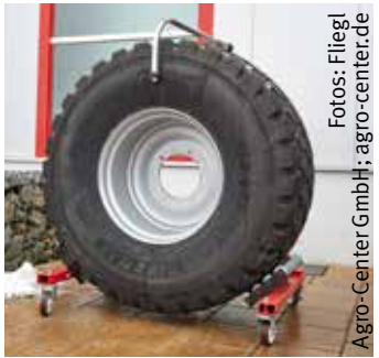
Der Sicherungsarm des Reifenwechselwagens wird oben am Reifen fixiert.
