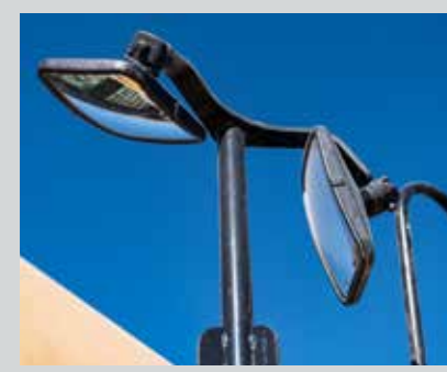
Diese Spiegel wurden für die Sicht auf die Vorderräder am großen Radlader installiert. Damit diese nicht durch große Steine beschädigt werden.
