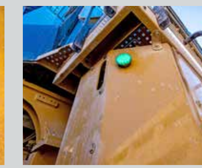
Die grüne Leuchte außen am Radlader zeigt, dass sich der Fahrer in der Kabine ordnungsgemäß angeschnallt hat.
