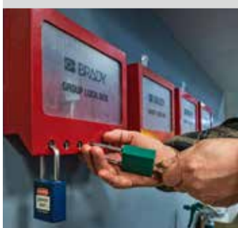
Der Anlagenschlüssel befindet sich so lange in einer Box, bis der letzte Mitarbeitende sein Schloss entfernt hat.
