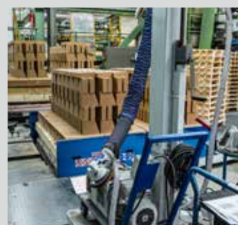
Die Fahrstuhl-Box, mit der die feuerfesten Produkte heruntergefahren werden können, macht das Entladen am Boden sicherer. Eine innovative Mitarbeiteridee!
