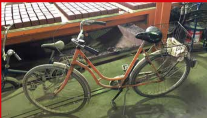
Zwei in die Jahre gekommene Drahtesel als Betriebsfahräder. Nicht verkehrssicher, schlecht erkennbar ohne Licht, Reflektoren und Rückstrahler. Und geparkt direkt neben einer Umlaufanlage.
