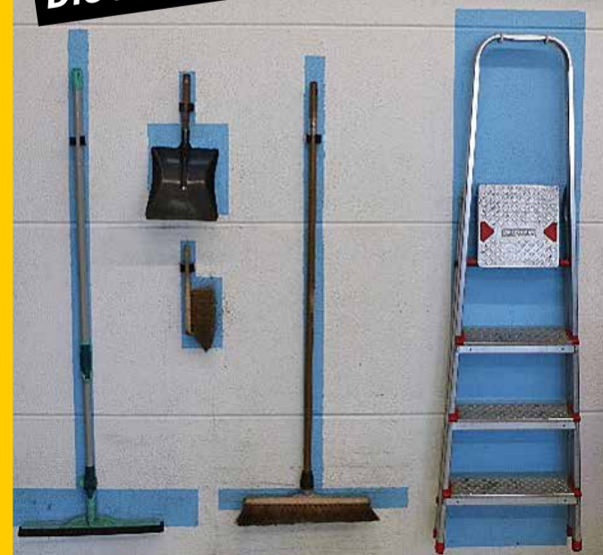
Zur 5S-Methode gehören feste Plätze für die einzusetzenden Arbeitsmittel, wie z. B. Leitern.
