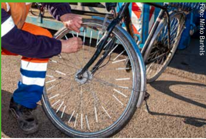
Ein verkehrssicheres Betriebsrad mit Licht und Speichenreflektoren. Wichtig fürs Sehen und Gesehenwerden bei schlechten Licht- und Sichtverhältnissen wie Dämmerung, Dunkelheit, Regen, Nebel.
