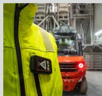
Das Alarmsystem warnt durch Signaltöne und Licht Fußgänger und Staplerfahrer gleichzeitig, bevor es gefährlich wird.
