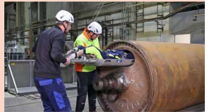
Die auf der Rettungstrage sicher fixierte Person wird von innen nach außen durch das enge Mannloch geschoben.
